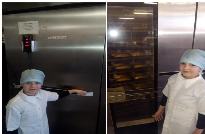
Дальше хлеб отправляют в печь. Печи современные электрические. Телега с хлебом туда просто закатывается и вращается чтобы пропечься равномерно.
